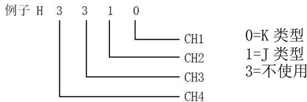
●每个通道的 A/D 转换时间为 240 毫秒。当有通道设置位“3” (不使用) 时, 对应的通道不执行 A/D 转换。因此总的转换时间减少。上面的例子中, 转换时间如下:
