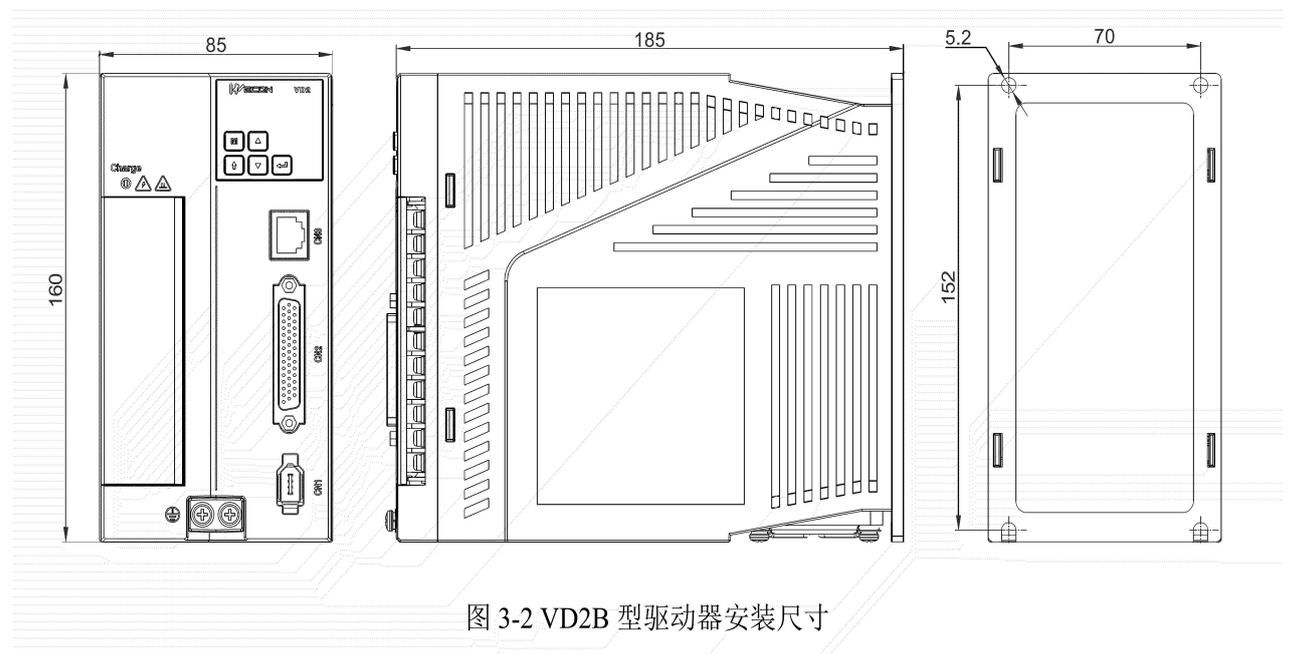
图 3-2 VD2B 型驱动器安装尺寸
